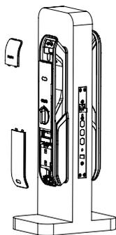
8 裝上電池，扣上電池蓋，裝上側扣板組件之後智能鎖安裝完成。
