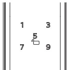
門鎖在處於反鎖狀態下，外部電子功能鎖定。手動喚醒系統時，鍵盤區域會顯示15937(X)，並語音提示已反鎖，表示已經啟動反鎖。
