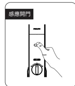
手柄上設計有傳感器，在觸發紅外感應的情況下，手同時握住手柄的前、後觸摸感應模塊即可解鎖。
