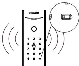
**觸發機制:** 當系統喚醒後, 將自動檢測電池電壓, 當電池電壓不足時, 發出警報, 提示您及時更換電池
