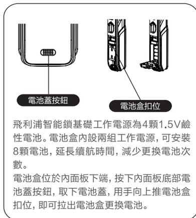
飛利浦智能鎖基礎工作電源為4顆1.5V鹼性電池。電池盒內設兩組工作電源，可安裝8顆電池，延長續航時間，減少更換電池次數。
