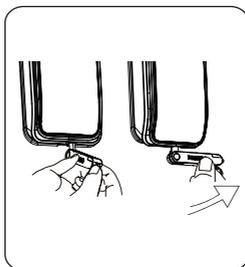
② 把機械鑰匙插入鎖孔，鑰匙套與鑰匙成垂直90°，鑰匙套向執手方向旋轉90°，直至靠近門面。
