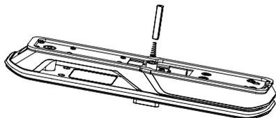
6 將外面板連接線及鎖體連接線插入內面板對應的插座中，再將內面板上的方軸對準鎖體上的轉動口插入，內面板緊貼門內面。
