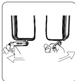
③ 將鑰匙套向下旋轉180°，使鑰匙套平行於水平面。向執手方向水平旋轉鑰匙套，即可開鎖。
