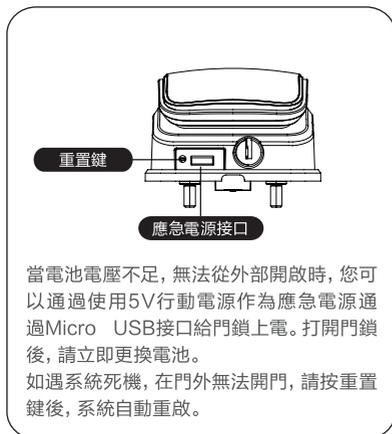
當電池電壓不足，無法從外部開啟時，您可以通過使用5V行動電源作為應急電源通過Micro USB接口給門鎖上電。打開門鎖後，請立即更換電池。
