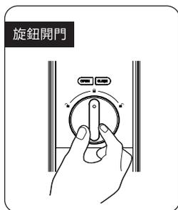
易鎖採用室內快開鎖體，直接旋轉旋鈕進行開鎖。
