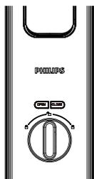
在智慧鎖處於已上鎖狀態時，下壓並扭轉旋鈕至左邊或右邊的上鎖刻度處
